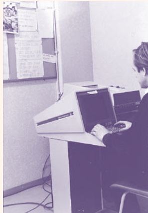
Figuur 5. Jan Kraak achter een Tektronix grafische terminal met daarnaast een hardcopy-apparaat, ca. 1979.
