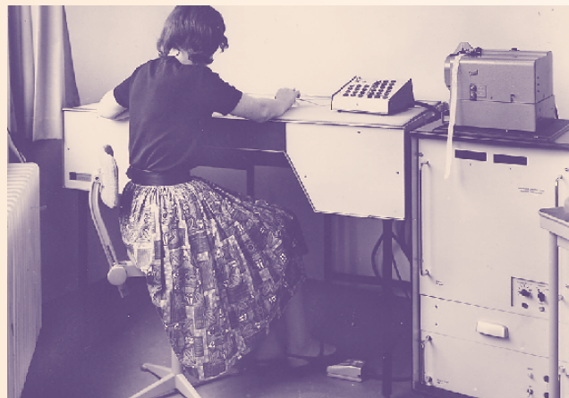
Figuur 2. Op de anti-plotter digitaliseren met een 'muis avant la lettre', 1965.
