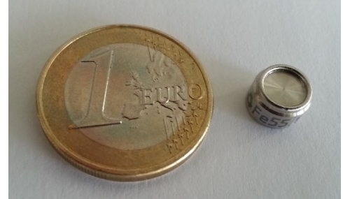
Figuur 1 - ^{55}\text{Fe} -kalibratiebron naast euromuntstuk
