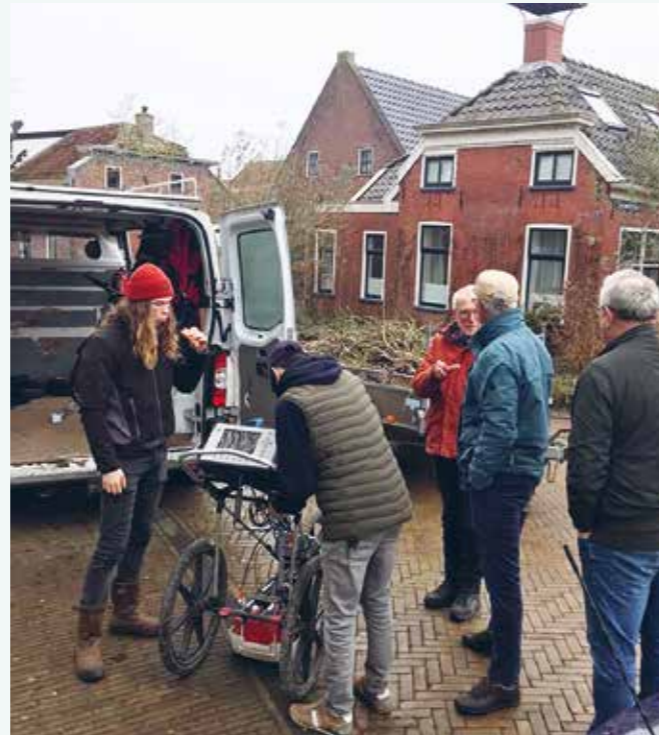
De grondradar van Medusa Explorations staat op het onderstel van een kinderwagen, zodat men ook de tuinen van bewoners kan meten.
